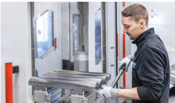
Osazování paralelně s hlavním časem je jednou z mnoha výhod automatizačního řešení HS flex heavy od HERMLE.
