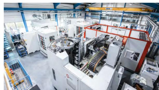
Na obou strojích C 22 U (v pozadí) obrábí TVB pouze grafit. Robot nakládá na C 32 U (vpředu vpravo) hliníkové a mosazné díly.
